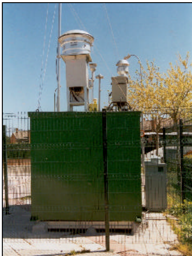
Estación de control de Alcobendas en la que se pueden ver los captadores de partículas instalados por el MIMAM y los de la Comunidad de Madrid.
